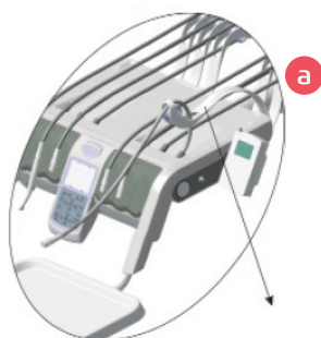
LIGADO Haste do micromotor deslocada para frente
