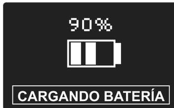
El final del ciclo de carga de la batería se indica con el mensaje **"BATERÍA CARGADA"**. El usuario puede retirar la fuente de alimentación, cerrar el compartimento inferior y utilizar el equipamiento.
