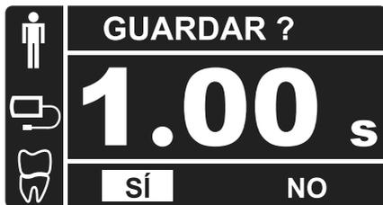
El nuevo valor se guardará en la posición del perfil del paciente, el tipo de receptor y el tipo de diente que se ha cambiado. Después de ser guardado, al seleccionar esta posición se mostrará el nuevo valor.
