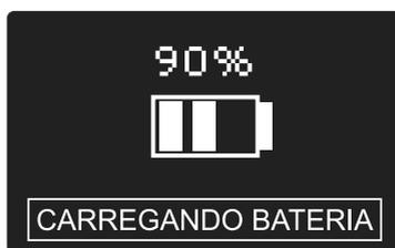
O fim do ciclo de carga da bateria é indicado pela mensagem “**BATERIA CARREGADA**”. O usuário pode retirar a fonte de alimentação, fechar o compartimento inferior e utilizar o equipamento.
