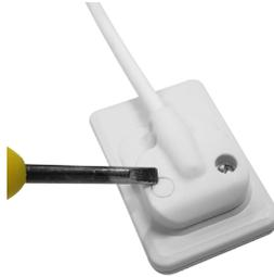
Con el destornillador con punta 3 x 0,8 mm remover los tornillos de fijación del cable.
